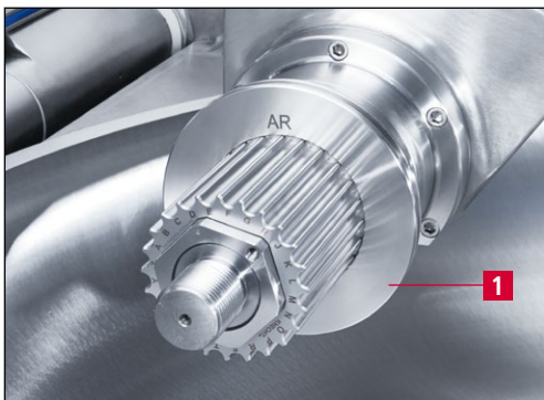
Bild 5-1 Anfangsring (AR) einbauen
