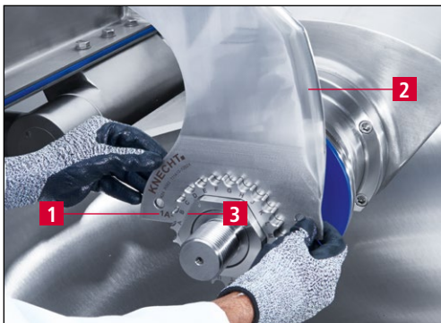
Bild 5-4 K 24 Kuttermesser einbauen
